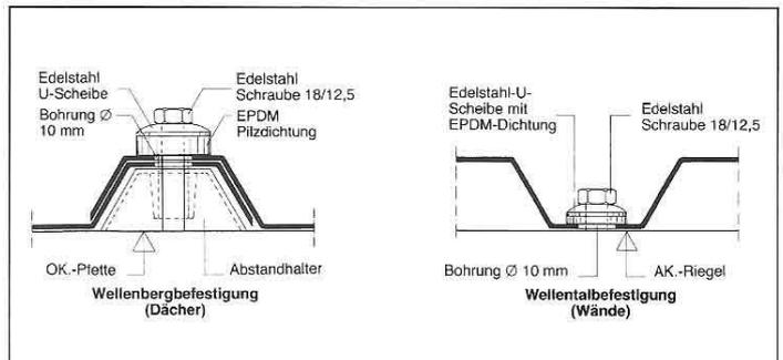
**Schrauben:** Die Dachbefestigung erfolgt auf dem Wellenberg mit Abstandshaltern. Im Wandbereich im Wellental befestigen. Befestigungen sind entsprechend der ONDEX®-Bauanleitungen und bauaufsichtlicher Zulassung auszuführen.
