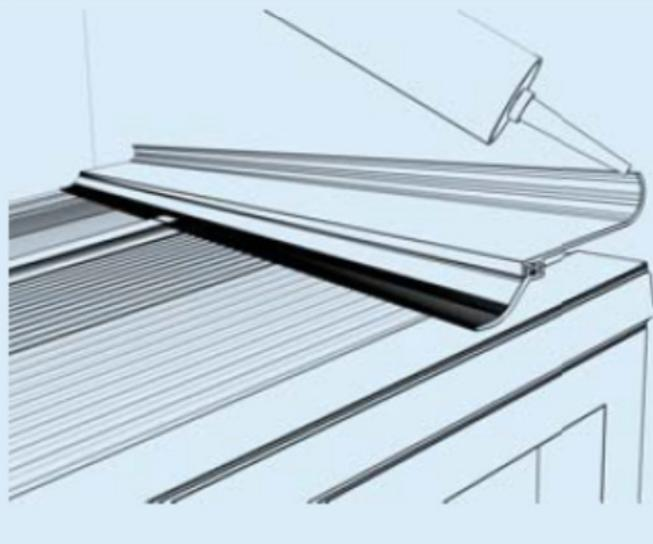
Das Wandanschlussprofil sollte in Abständen von ca. 300 mm in einer Linie so angeschraubt werden, dass das Wandanschlussprofil bei der Montage gleichmäßig auf den Aluminiumsprossen aufliegt. Das Anschlussprofil ist zum angrenzenden Bauteil mit geeigneter Dichtmasse (Silikon) abzudichten.
