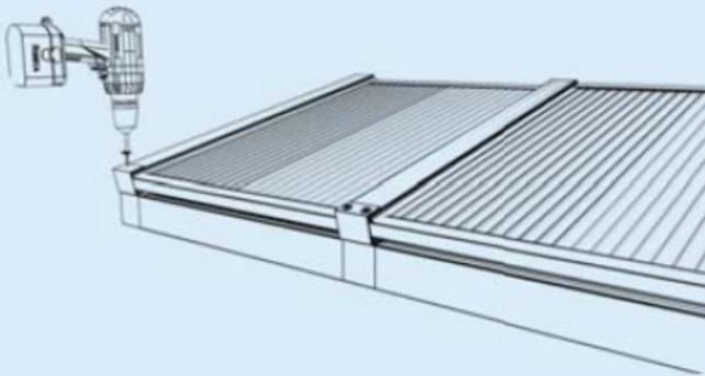
Die Haltewinkel werden auf die Alu-Profile geschraubt, um die Stirnseiten zu verschließen und das Herausrutschen der Hohlkammerscheibe zu verhindern.
