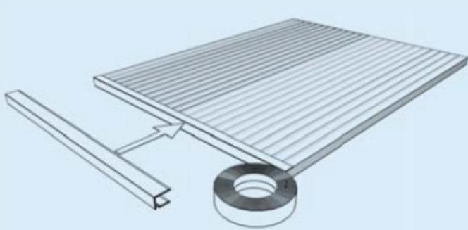
Die Hohlkammerscheibe wird an den beiden Stirnseiten mit einem Anit-Dust-Tape verschlossen. Dies verhindert das Eindringen von Schmutz und Insekten. Anschließend wird das Alu U-Profil mit der Tropfkante nach unten zeigend auf beide Stirnseiten der Scheibe gesteckt. U-Profile unterstützen so zusätzlich die Querstabilität der Platte.
